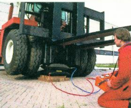
Baumaschine geht in die Luft: Die flexible Drucklufttechnik macht's möglich. Foto: Traco
